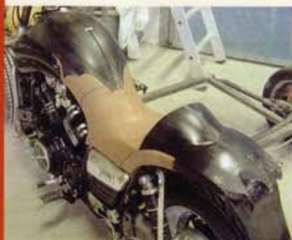
Der Übergang zwischen zwischen Sitz und Tankschale ist fließend.
