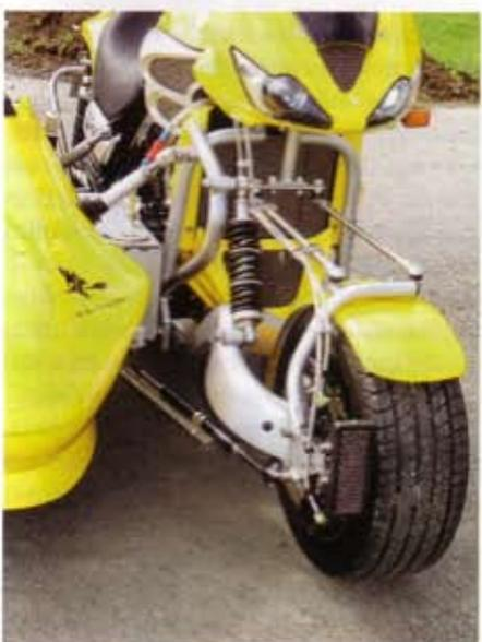
Die Achsschenkellenkung führt zielgenau und spurtreu. Am Vorderrad zu sehen ist der Lufteintritt für die Bremsscheibenzwangskühlung.
