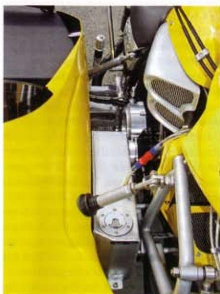
Der Zusatztank sitzt zwischen Motorrad und Beiwagen. Gefüllt bringt er Gewicht auf das Vorderrad.
