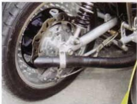
Der Luftschlauch bringt Kühlung an die hintere Bremsscheibe.
